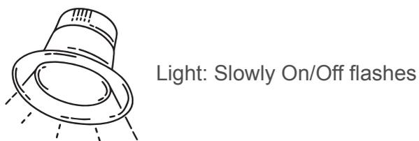
(d) Press the key of unpaired switch ONCE to complete the pairing.
